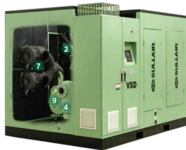
设计采用带防护罩的弹性联轴器，有效减弱和吸收主机及电机间的振动传递，可径向拆装的结构设计，配合连接筒的精心设计可实现永久对中，为维护带来了极大的便利性。
